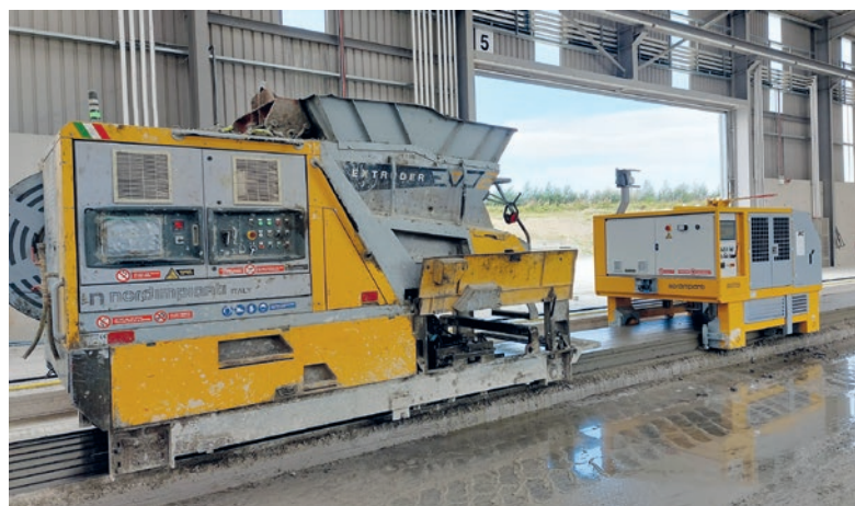
El nuevo plóter funciona en combinación con la extrusora EVO2, suministrada en el año 2022
