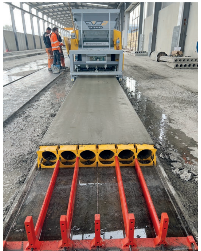
Extrusora EVO2 durante el hormigonado
